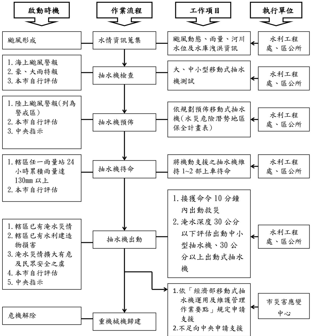
圖 3-3、移動式抽水機運用流程圖
